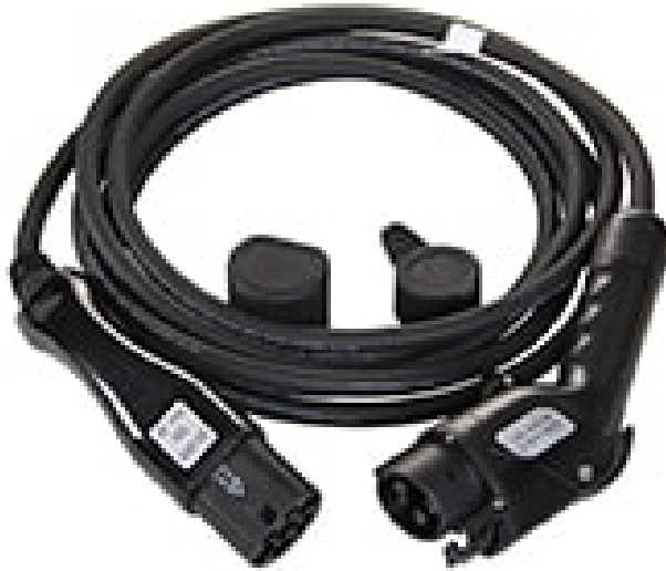
Câble de recharge véhicule électrique 32A Monophasé Type 2 - Type 1 (7,4kW)
